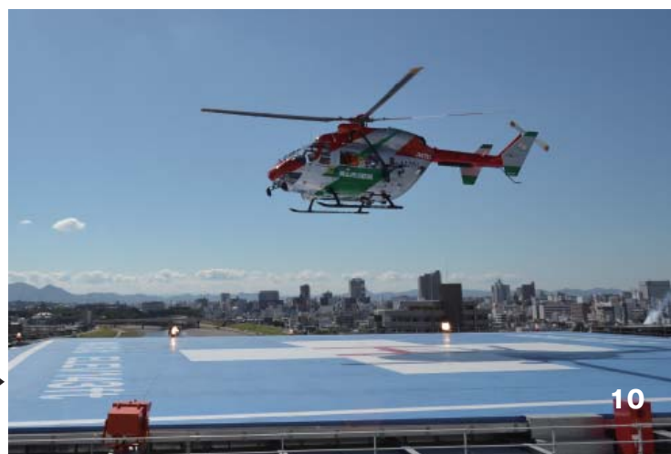
ヘリポートは建物から1/3突き出し、ICU、手術室などへ乗り換えなしで患者を搬送できる▶
